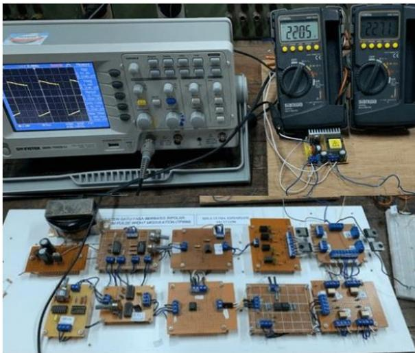
Gambar 19. Pengujian inverter satu fasa
