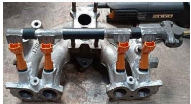
Gambar 8 Delivery Pipe Sesudah Dimodifikasi
