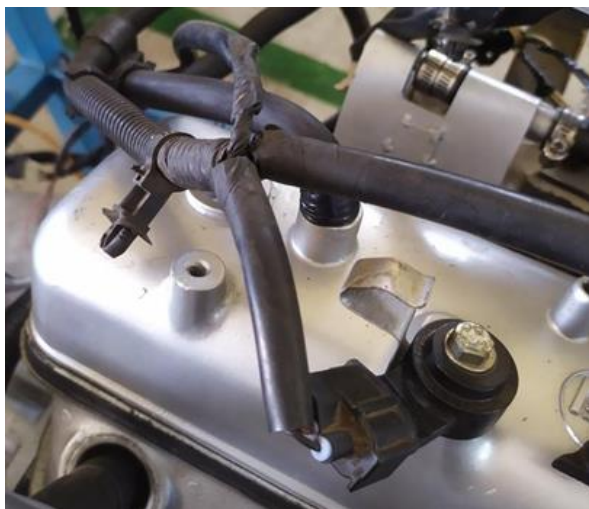
Gambar 20. Penempatan Knock Sensor
