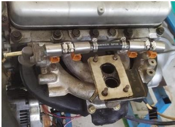
Gambar 10. Pemasangan Intake Manifold dan Delivery Pipe
