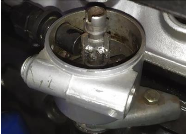
Gambar 14. Pemasangan Distributor dan Sensor CMP
