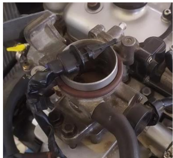
Gambar 18. Penempatan Sensor IAT
