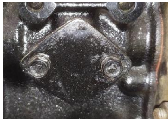
Gambar 13. Pemasangan Tutup Ex Pompa
