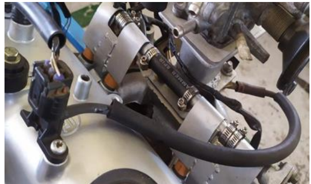
Gambar 17 Penempatan MAP Sensor
