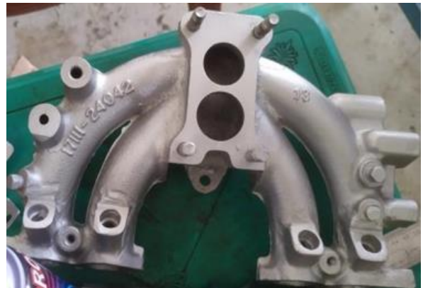
Gambar 7. Intake Manifold Sesudah Dimodifikasi
