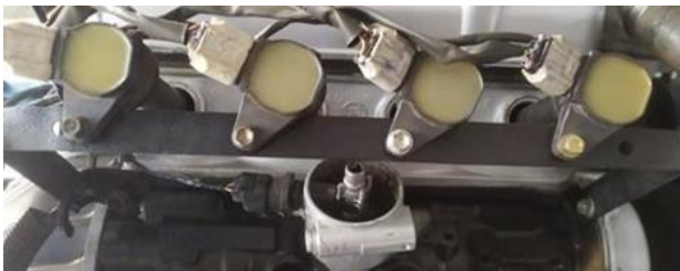
Gambar 15. Pemasangan Dudukan dan Ignition Coil
