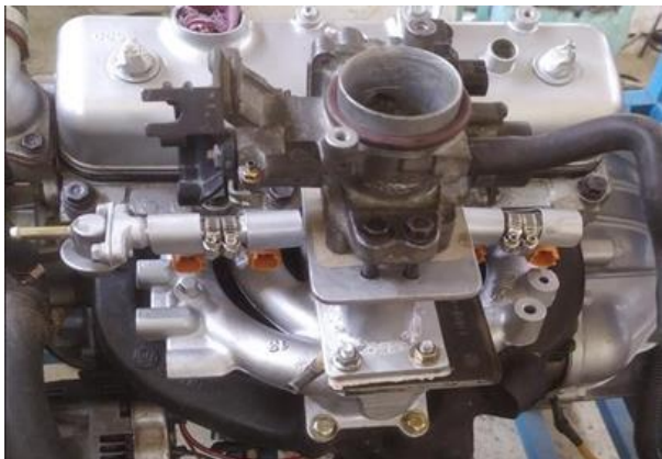
Gambar 11. Pemasangan Surtage Tank Dan Throttle Body
