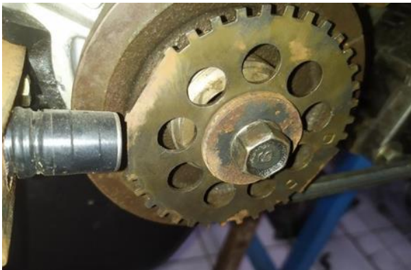
Gambar 19. Penempatan Sensor CKP dan Gigi Sensor CKP
