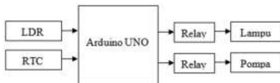
Gambar 2. Diagram Blok Alat
