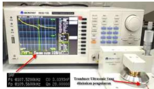
Gambar 5. Pengukuran frekuensi respon pada transduser ultrasonic
