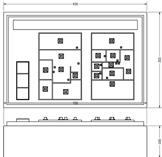
Gambar 4. Dimensi Alat Peraga Instalasi Penerangan
