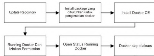
Gambar 7. Tahapan Instalasi Docker CE
