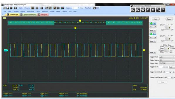
Gambar 14. Output Zero Crossing Detector pada fasa  $240^{\circ}$
