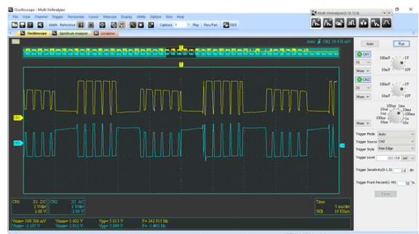
Gambar 30 Output Sinyal Pada Modul Beda Polaritas 240^\circ
