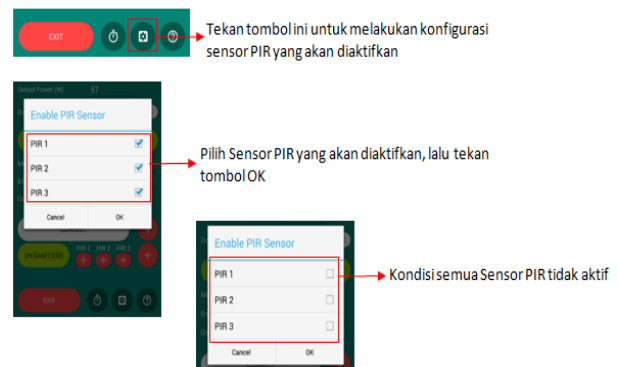
Gambar 9. Cara pengaturan sensor PIR
