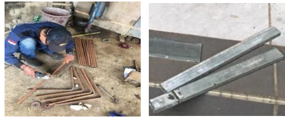
Gambar 3 : Pemotongan Pipa dan Hollow
