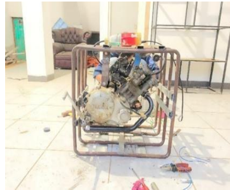
Gambar 8 : Proses Perakitan Mesin Ke Rangka.
