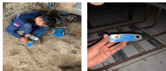
Gambar 5 : Pemotongan dan Pengeboran mounting
