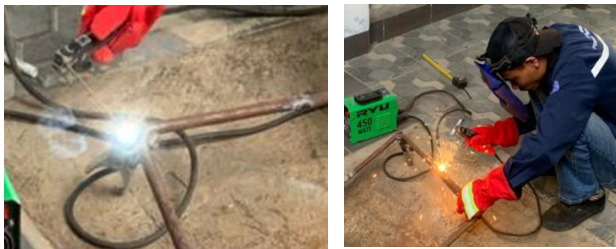
Gambar 6 : Pengelasan tekukan dan sambungan pipa
