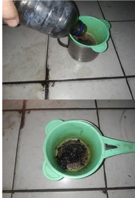
Gambar 8. Proses pemisahan cairan dengan kerak karbon
