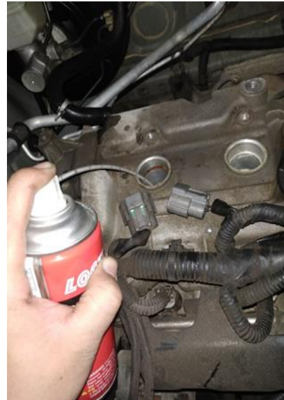
Gambar 4. Penyemprotan cairan ke ruang bakar melewati lubang busi
