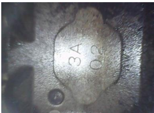
Gambar 7. Foto permukaan kepala torak dengan kamera endoskop dari lubang busi setelah kerak dibersihkan
