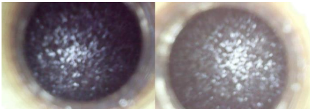
Gambar 6. Foto permukaan kepala torak dengan kamera endoskop dari lubang busi sebelum kerak dibersihkan
