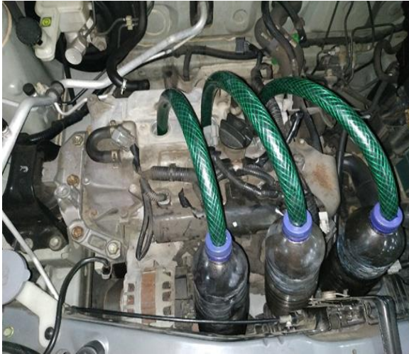
Gambar 5. Proses menampung cairan beserta kerak karbon
