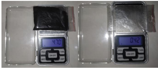
Gambar 10. Pengukuran berat kerak karbon Berat kerak karbon = berat total – berat kemasan
