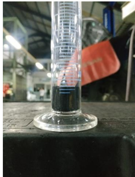
Gambar 9. Pengukuran volume kerak karbon
